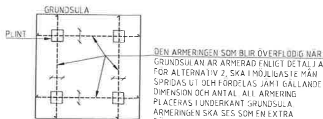
DETALJ D 1:100 PRINCIPDETALJ FÖR EXTRA ARMERING GÄLLER ENDAST ALTERNATIV 2
