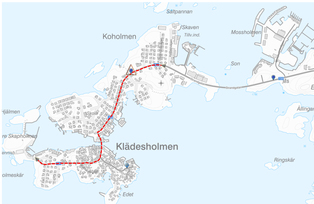
Figur 24. Genomsnittlig årsdygnstrafik för rödmarkerad vägsträcka, totalt antal fordon 1000, andel tunga fordon 2,8% (Vägrafikflödeskartan, Trafikverket, 2023)
