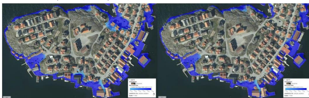
Figur 32. Utbredning av översvämning för Södra Koholmen vid högsta beräknade högvatten år 2120 (3,1m). Vänstra bilden visar översvämningsutbredning utan åtgärder och högra bilden med identifierade åtgärder integrerade. Översvämningsdjupen på vägen som förbinder Koholmen med Klädesholmen överstiger inte 10 cm så framkomligheten för persontrafik och utryckningsfordon är säkerställd (Sweco, 2022).
