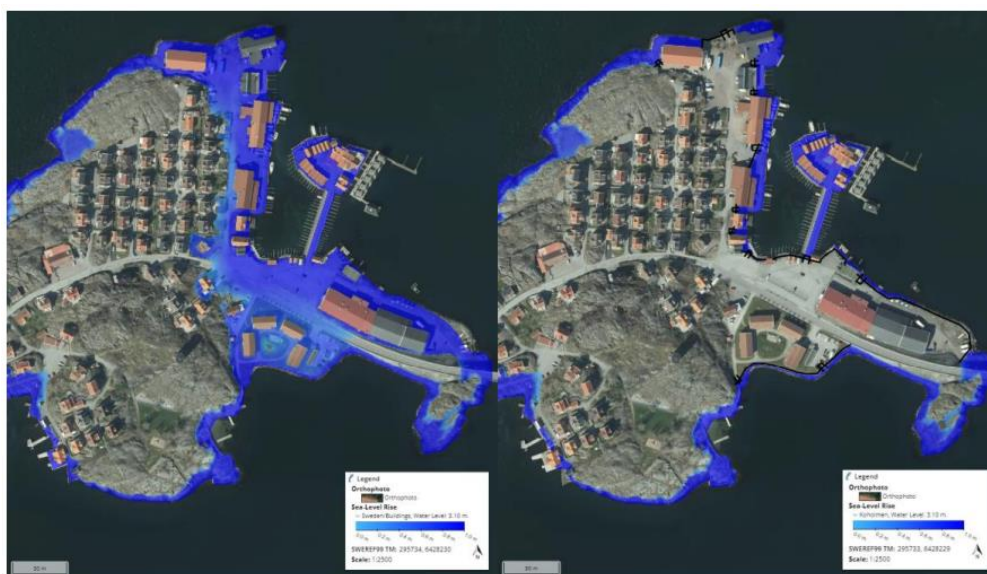
Figur 31. Utbredning av översvämning för Norra Koholmen vid högsta beräknade högvatten år 2120 (3,1m). Vänstra bilden visar översvämningsutbredning utan åtgärder och högra bilden med identifierade åtgärder integrerade. Översvämningen vid brofästet är missvisande då det bygger på ett modellantagande som inte är korrekt. Denna del av bron riskerar inte att översvämmas (Sweco, 2022).
