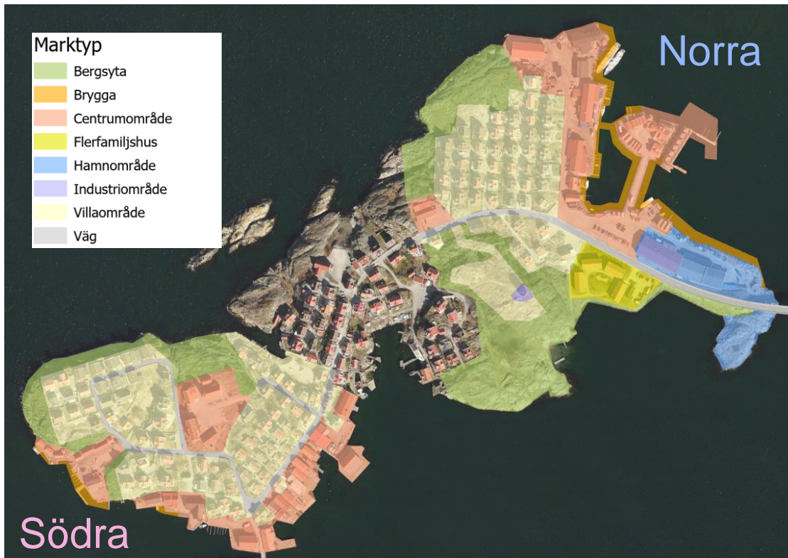
Figur 4-5. Ytor för beräkning av dagvattenflöden samt halter och mängder av föroreningar efter exploatering. Ortofoto bearbetat av Sweco.
