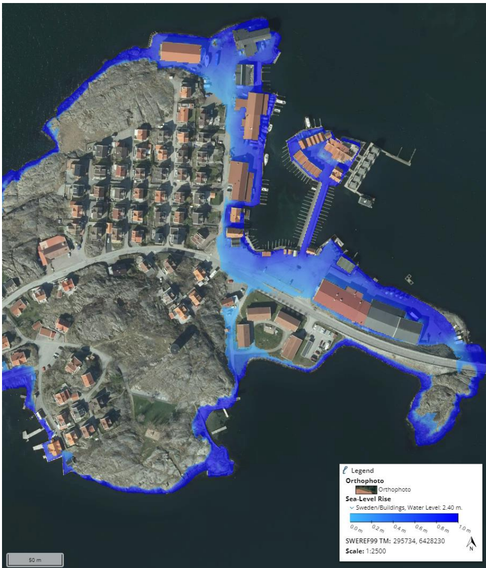
Figur 2-7. Översvämningsutbredning vid högsta beräknade högvatten år 2070 (~+2,4 m) Översvämnningen vid brofästet är missvisande då det bygger på ett modellantagande som inte är korrekt. Denna del av bron riskerar inte att översvämmas.
