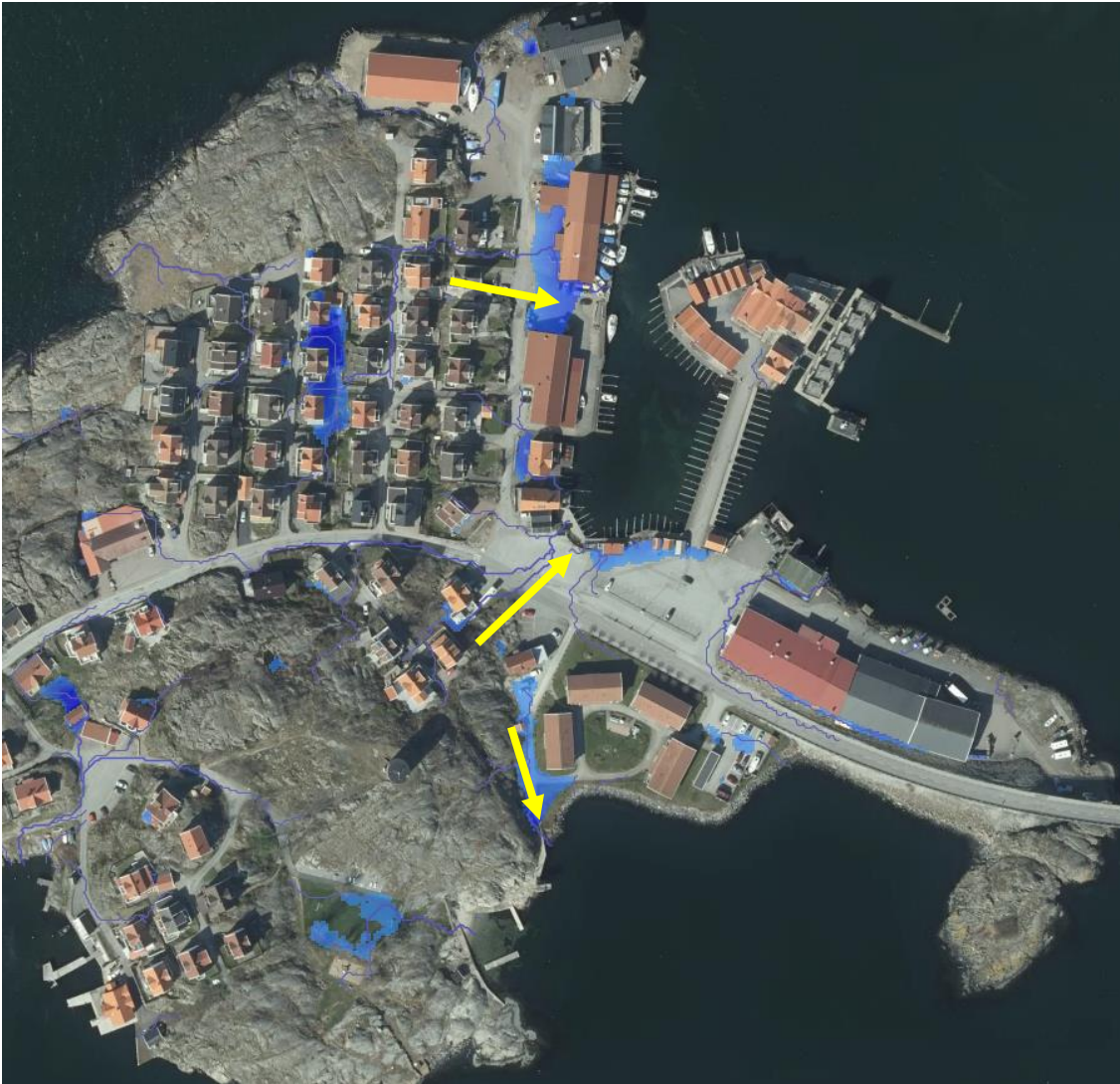
Figur 3-2. Skyfallsstråk (blå linjer) och vattendjup vid ett klimatanpassat 100-årsregn, endast lågpunkter som är djupare än 20 cm visas. Gula pilar indikerar tänkta öppningar där skyfallsvattnet ska kunna rinna igenom åtgärderna som föreslagits mot stigande havsnivåer.
