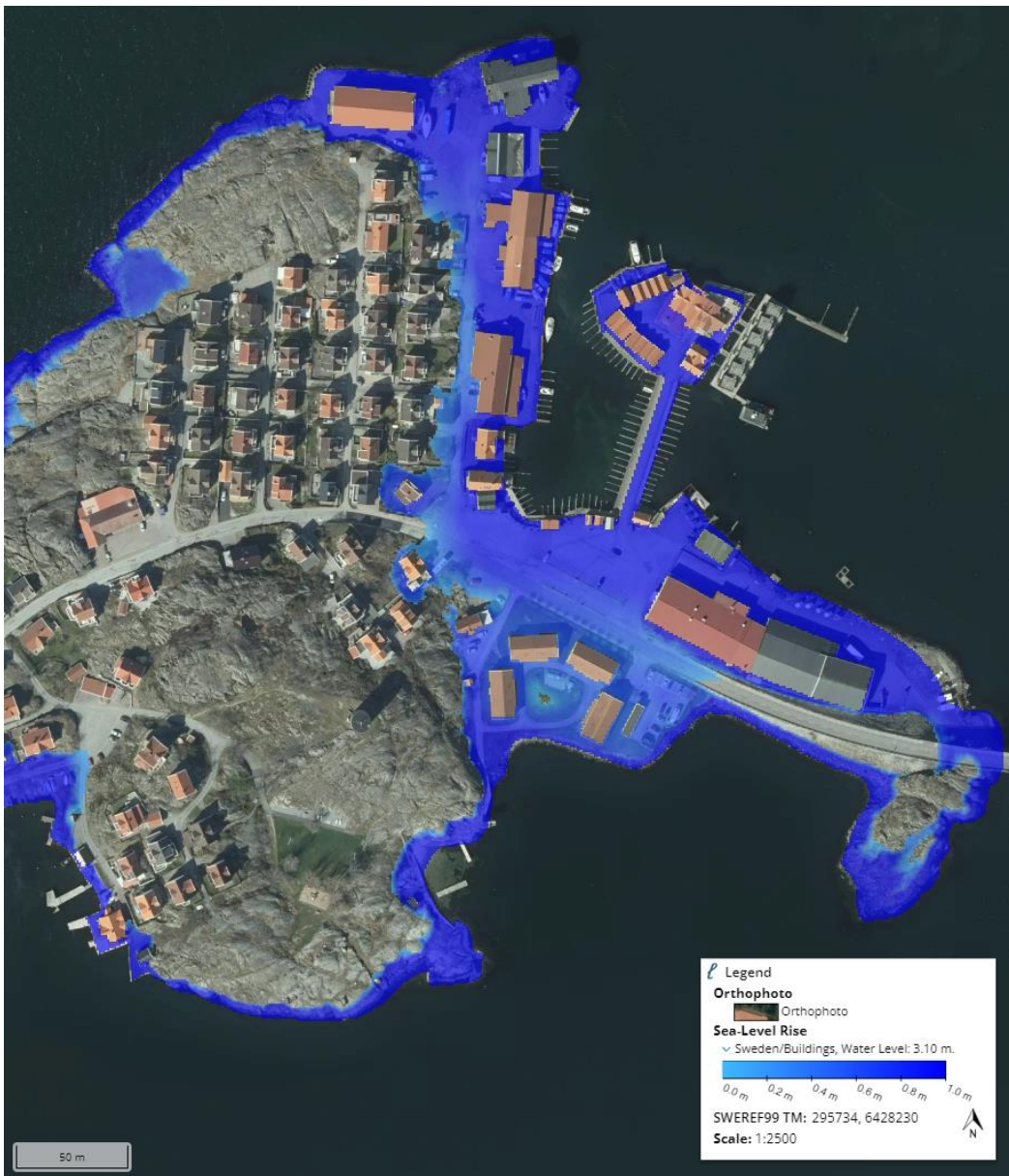
Figur 2-8. Översvämningsutbredning vid högsta beräknade högvatten år 2120 (~+3,1 m) Översvämnningen vid brofästet är missvisande då det bygger på ett modellantagande som inte är korrekt. Denna del av bron riskerar inte att översvämmas.
