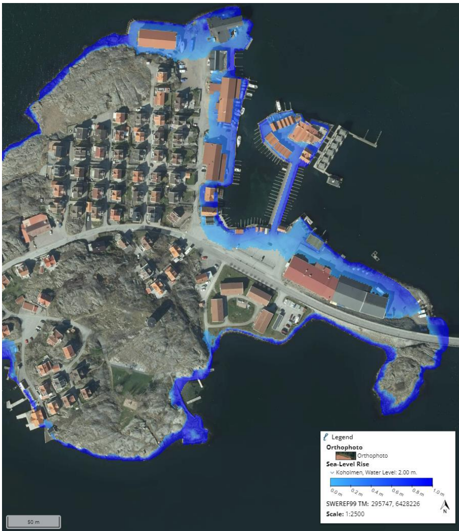
Figur 2-6. Översvämningsutbredning vid högsta beräknade högvatten i nuvarande klimat (~+2,0 m) Översvämnningen vid brofästet är missvisande då det bygger på ett modellantagande som inte är korrekt. Denna del av bron riskerar inte att översvämmas.
