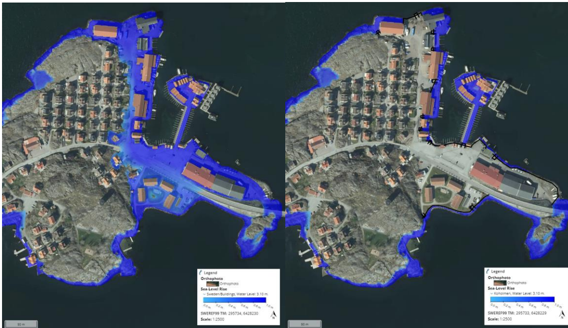
Figur 2-12. Översvämningsutbredning år 2120 i samband med ett högsta beräknade högvatten. Bilden till vänster visar översvämningsutbredningen utan åtgärder och bilden till höger visar översvämningsutbredningen med identifierade åtgärder integrerade. Översvämnningen vid profästet är missvisande då det bygger på ett modellantagande som inte är korrekt. Denna del av bron riskerar inte att översvämmas.
