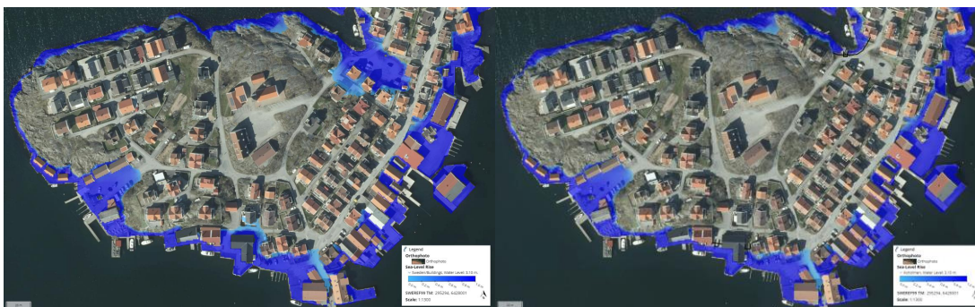
Figur 2-13. Översvämningsutbredning år 2120 i samband med ett högsta beräknade högvatten. Bilden till vänster visar översvämningsutbredningen utan åtgärder och bilden till höger visar översvämningsutbredningen med identifierade åtgärder integrerade. Översvämningsdjupen på vägen som förbinder Koholmen med Klädesholmen överstiger inte 10 cm så framkomligheten för persontrafik och utryckningsfordon är säkerställd.
