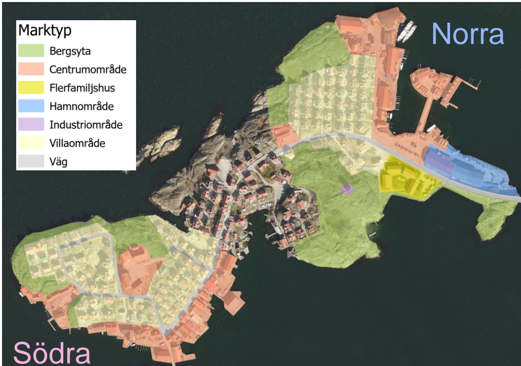
Figur 4-4. Ytor för beräkning av dagvattenflöden samt halter och mängder av föroreningar före exploatering. De olika marktyperna beskriver ytor som lades in i Stormtac och som flödes- och föroreningsberäkningar utgår ifrån. Ortofoto bearbetat av Sweco.
