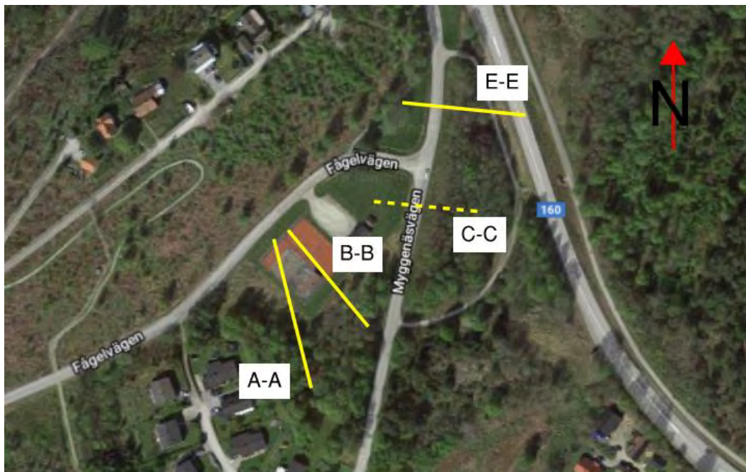
Figur 6.1 Beräknade stabilitetssektioner A-A, B-B, E-E samt C-C.
